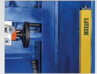
Optická čidla zabezpečují zadní prostor stroje.
