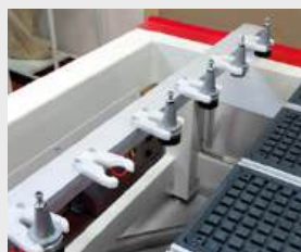
► Lineární zásobník na 6 nástrojů,
