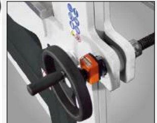
▶ Nastavení zadního dorazu pomocí ručního kola
