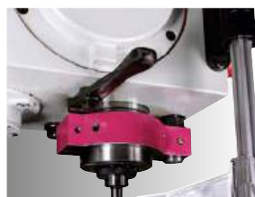
Vyražeč usnadňuje výměnu nástrojů
