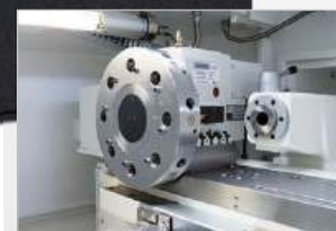
▶ Hydraulický výměník nástrojů VDI30 pro osm nástrojů
