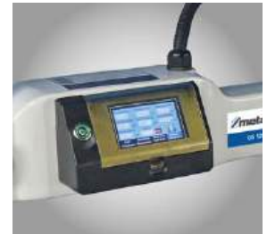
▶ Nastavení parametrů pomocí vestavěného displeje
