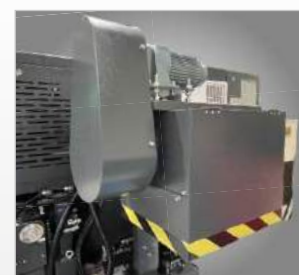
▶ Vynašeč třísek ▶ Namontován na zadní straně
