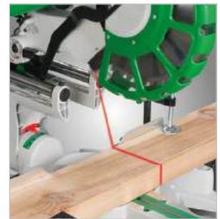
▶ Laserový ukazatel k vyznačení linie řezu
