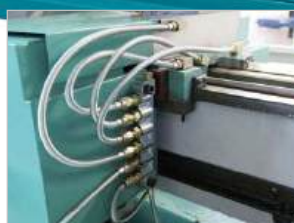
▶ Rozvod centrálního mazání
