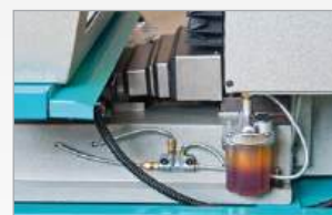
Centrální rozvod mazání
