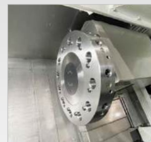
▶ Výměník na 12 nástrojů ▶ Servo VDI30
