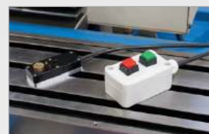
Senzor pro měření délky nástroje / tlačítko START/STOP
