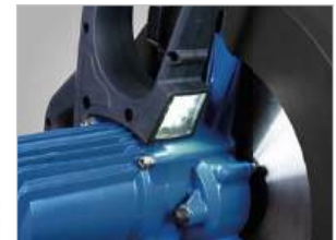
▶ LED pracovní osvětlení na spodní straně rukojeti
