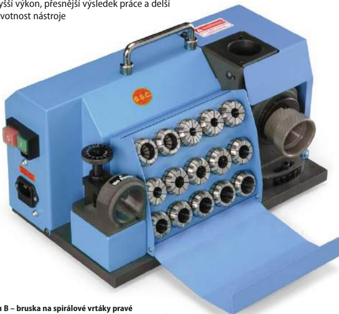
GS-21 B – bruska na spirálové vrtáky pravé ø 8 – 25,4 mm, 90 – 140°. S adaptérem a dodatečnou sadou kleštin (vol. příslušenství) pro průměr již od 3 mm.
