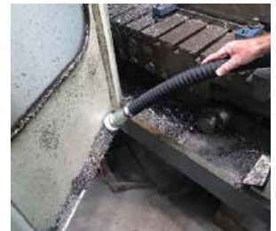
Nádobka z nerezové oceli je odolná proti ostrým hranám kovových třísek.
