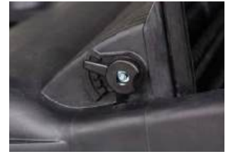
Jednoduché nastavení výšky zametacích válců
