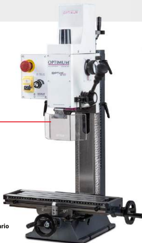
Sloup stranově přestavitelný o ±30 mm
