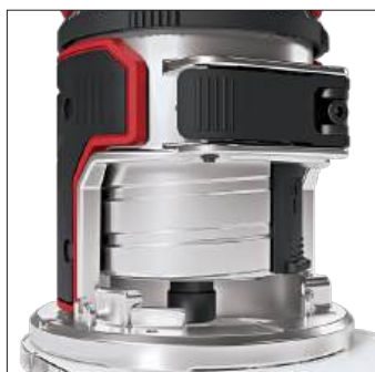
Jednoduchá a rychlá výměna frézy díky integrované aretaci vřetena.
